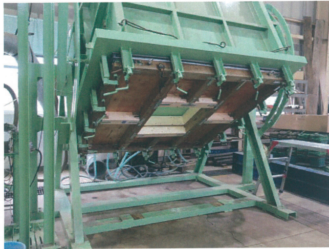
写真 4.1 水密性 試験実施状況（傾斜角 Q=30^\circ ）
